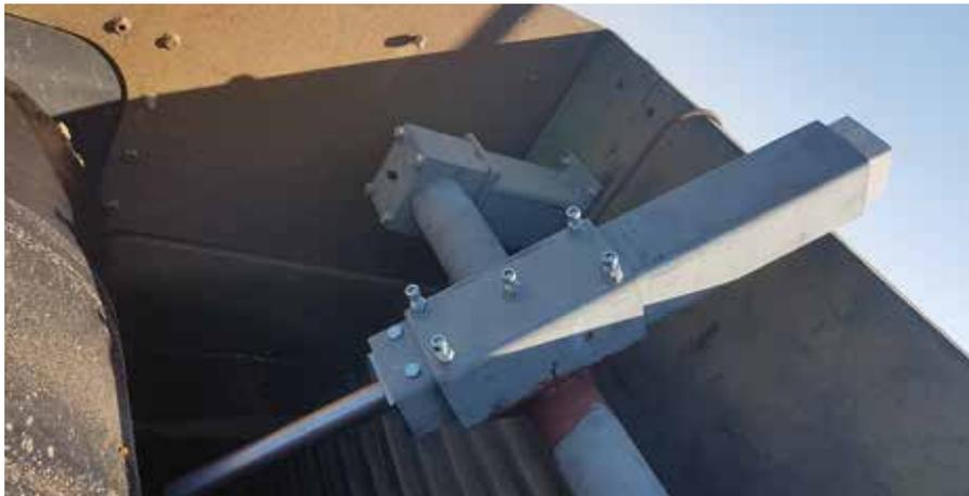
**AN DER BANDÜBERGABE** überwacht der Geoscaner über die Online-Messung der Korngrößenverteilung die Qualität von Kies (o.) und genauso steuert er an der Übergabe per Online-Messung der Korngrößenverteilung von gebrochenem Naturstein eine Siebanlage (u.). Fotos: TU Clausthal
