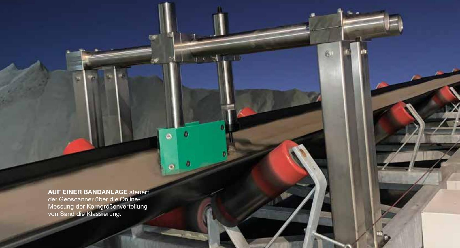
**AUF EINER BANDANLAGE** steuert der Geoscanner über die Online-Messung der Korngrößenverteilung von Sand die Klassierung.
